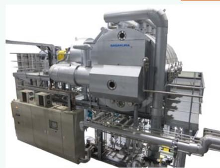
当社の蒸発濃縮装置は、海水を真水に変える海水淡水化技術をベースに、工場の製造過程における濃度調整や、有価物回収、廃棄される液体の減容化を目的とした装置です。省エネに優れたヒートポンプを活用して従来の蒸気を使うタイプに比べ、CO2 排出量換算で約 9 割の省エネを達成して、お客様の環境負荷を低減しています。これは、SDGs の目標「9 産業と技術革新の基盤をつくろう」の「環境に配慮した技術・産業プロセスの導入拡大」、「12 つくる責任、つかう責任」の「廃棄物の大気、水、土壌への放出」の削減に資することができます。
